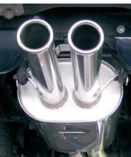
Sportauspuff-Anlagen umgibt fraglos ein Hauch Faszination, versprechen sie doch satten Sound und ein Plus an Motorleistung. In der Tat vermindern gewissenhaft konstruierte Anlagen den Abgasgegen- druck, was für einen besseren Gasaustausch im Aggregat sorgt.
