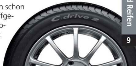
Wichtig ist in erster Linie, dass der Abroll-Umfang der Breitformate möglichst mit dem der Serienbereifung übereinstimmt – je genauer, desto eher ist die Rad-/Reifenkombination verwendbar. Ansonsten weicht die Tachonadel zu drastisch vom tatsächlichen Tempo ab.
